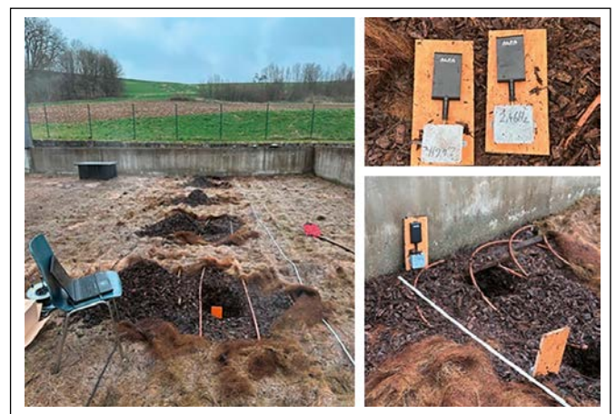
Abbildung 3: Feldversuch zur Reichweitenmessung am Biofilterstandort Backnang unter realen Einsatzbedingungen im offenen Biofiltermaterial. Oben rechts: Richtantennen mit hoher Verstärkung.
