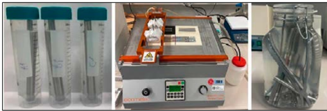
Abbildung 2: Versuchsaufbau der drei Methoden (Eintauch- und Abriebprüfung)
