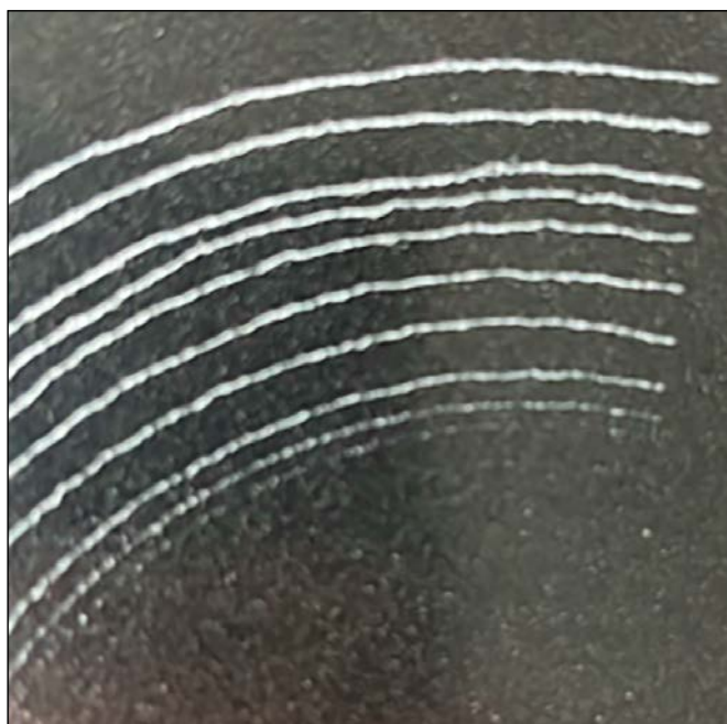
Abbildung 5: Kratzspuren verschiedener Stärken auf der Oberfläche eines Quarzkomposits
