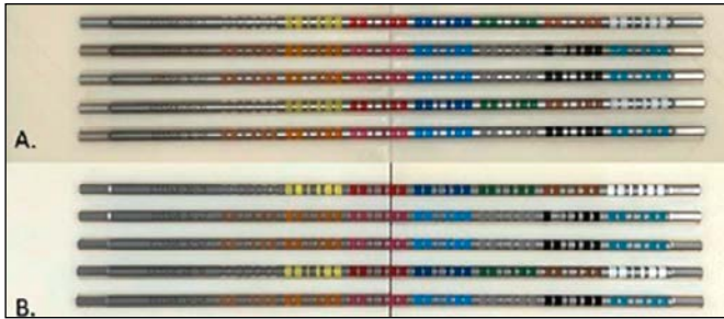
Abbildung 4: Farbringe vor (A) und nach (B) dem Abriebtest
