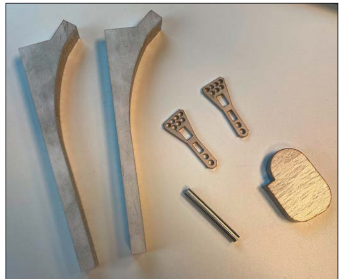
Abbildung 1: Verschiedene Prüfkörpergeometrien: Hüftimplantat, IPG, Radiusplatte (+ Zylinderprobe)
