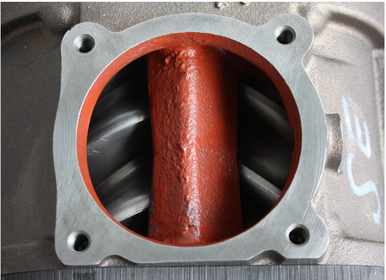
Abbildung 1: oben : Frontansicht des Expanders mit der großen Auslassöffnung auf der Oberseite (nicht sichtbar: Einlassseite unten) mit Abtriebswelle und Passfedernut sowie unten : Detail-Ansicht der Auslassseite. Zu sehen sind die beiden Rotoren (sogenannte twin-screw Ausführung). Zur Maßstäblichkeit: bei den abgebildeten Schraubverbindungen handelt es sich um M8-Gewinde.
