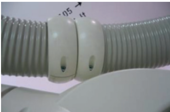
Abbildung 2: Rillenzwischenräume und Schraubenvertiefungen sind nur schwer zu reinigen
