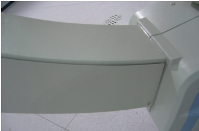
Abbildung 1: Spalte zwischen Chassis führen zu einer schwierigen Reinigung
