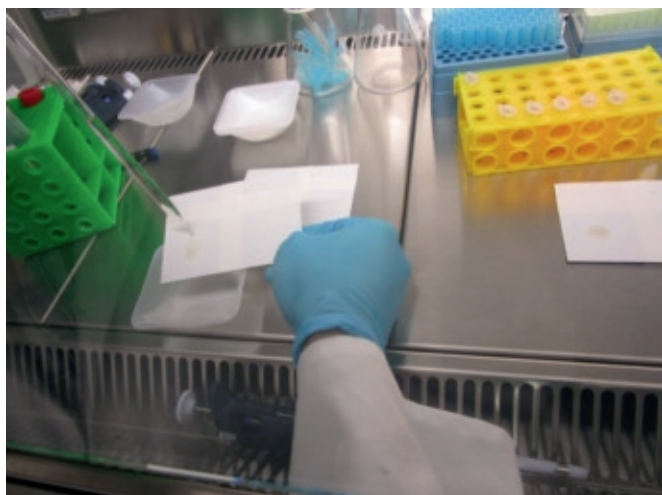
Abbildung 4: Abspülen des bebrüteten Inokulums von der Probeplatte
