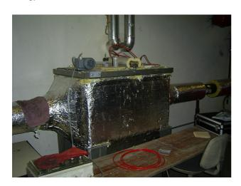
**Abb. 3**: Der Prototyp des Kleinelektrofilters auf dem Prüfstand
