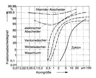
**Abb. 1**: Abscheidegrade von Staubabscheidern in Abhängigkeit von der Korngröße (Fraktionsabscheidedrad) nach /4/
