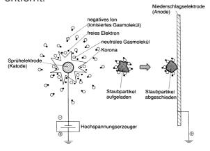
**Abb. 2.:** Prinzip des elektrischen Abscheiders nach /4/
