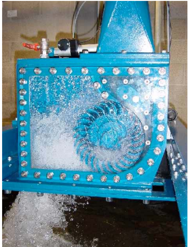
Die Turbine beim Anlauf
