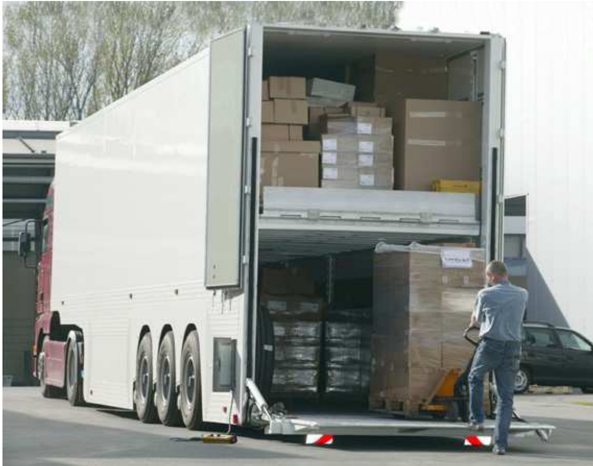
Abb. 3 Doppelstockfahrzeug mit Einzelradaufhängung und Außenlift [KRA-10]
