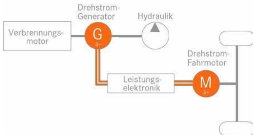
Abb. 5 Antriebskonzept eines diesel-elektrischen Staplers [STI-10b]
