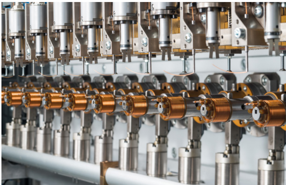
Vollautomatisches Wickeln von Spulen
