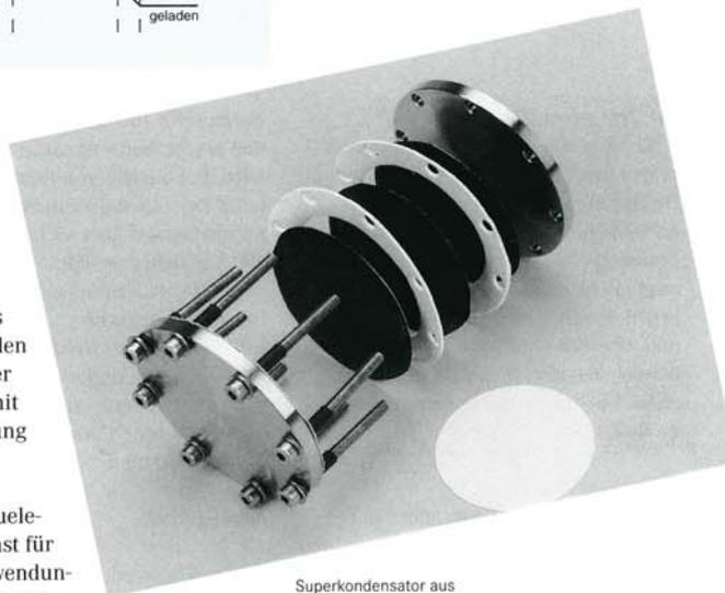
Superkondensator aus bipolaren Metalloxidelektroden, keramischen Separatoren und Dichtungselementen.
